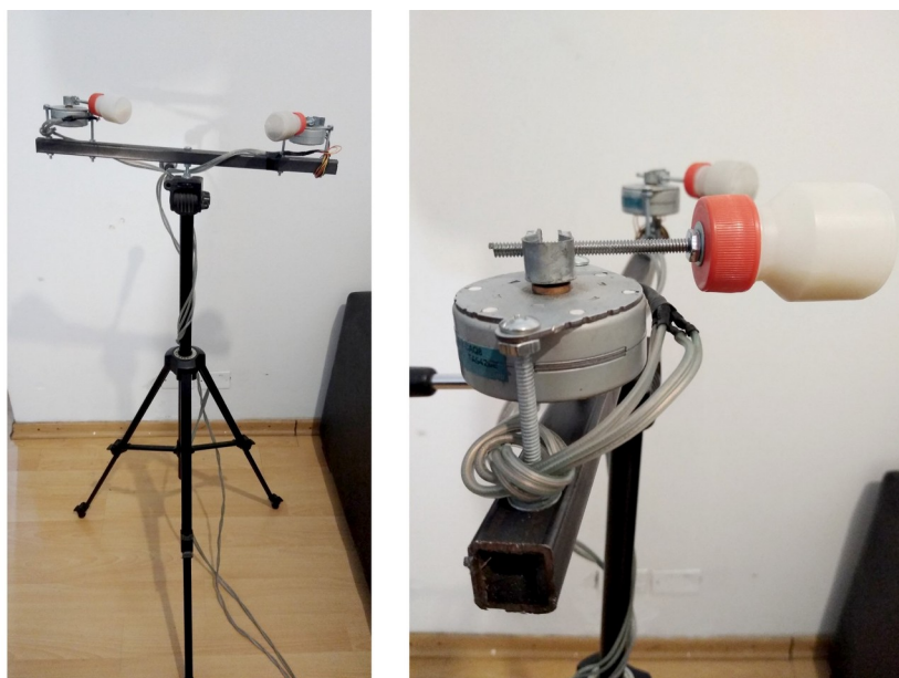
Fig. 62: PulsAr-TaboT. Detalle mecanismo interno de atenuación y control de tensión de parche.
